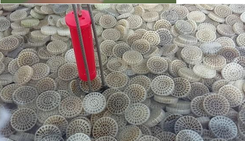
AnoxKaldnes dragermateriaal en werking van de MBBR
