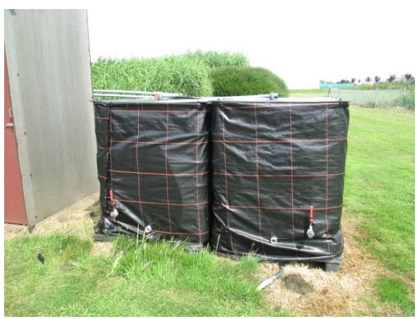
Opstelling van een fosforfilter bestaande uit twee units met verschillende adsorptiematerialen. - Links: fosforfilter gevuld met pellets van ijzerslib - Rechts: fosforfilter gevuld met ICS korrels
