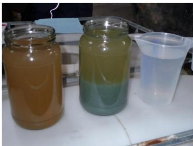
Laboproef werking Sentinel (links: oorspronkelijk restwater, midden: bezinking vlokken na toedienen chemische middelen, rechts: gezuiverde waterlaag na actief kool filter. ( https://www.inagro.be/DNN_DropZone/Publicaties/453/Brochure_zuiveringssystemen.pdf ))
