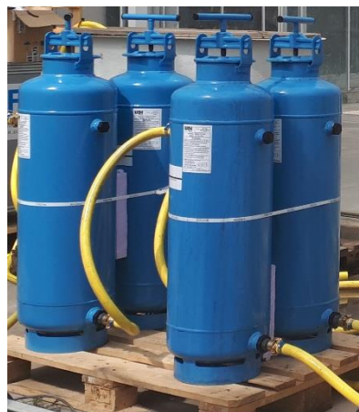
Proefopstelling waarbij het drainwater door een snelle zandfilter gaat, gevolgd door een actief kool filter met granulair actief kool.
